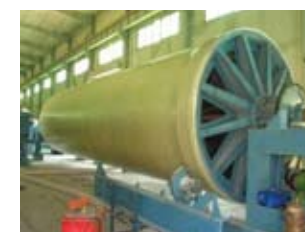
Изготовление внутреннего слоя
